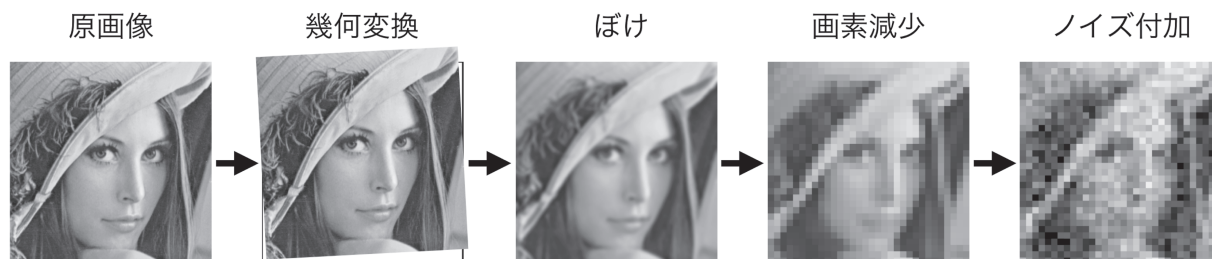
図 2 順過程。原画像に幾何的な変換 (位置ずれ)、ぼけ、画素減少 (縮小)、ノイズ付加が実行されて観測画像になる。
