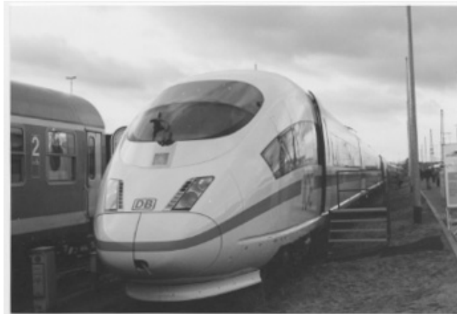
図6 電車方式を採用したドイツの高速車両ICE 3
