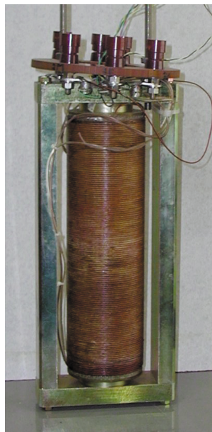
図 2 : 試作無誘導巻線限流器
