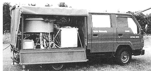
図1：車載型Sバンド境界層レーダー
