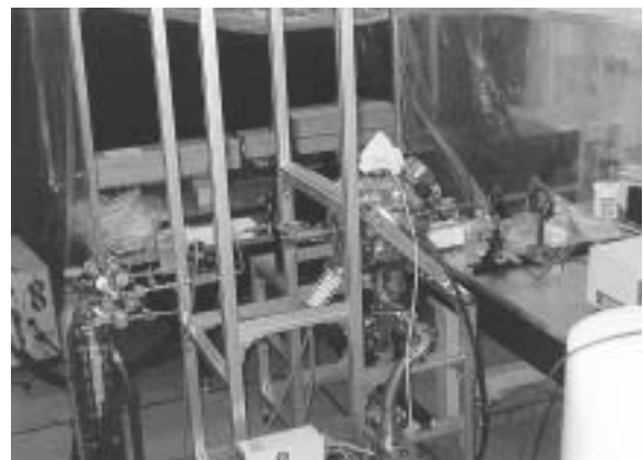
図3：レーザ誘起蛍光法による電界強度分布測定
