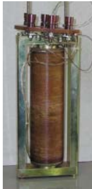
図 2 : 試作無誘導巻線限流器
