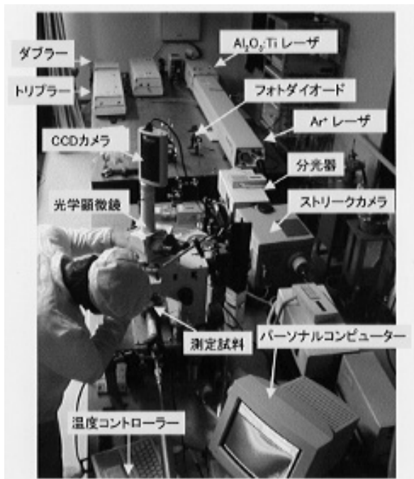
図1 顕微-時間分解PL測定装置の全体写真
