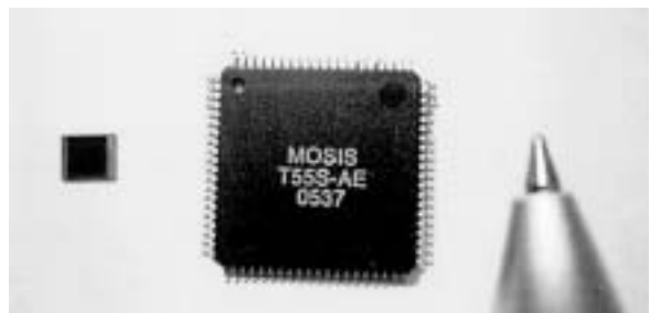
図2. 試作したアナログASIC. 7チャンネルの差動アンプ、LPFなどを実現させている。
