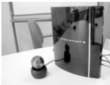
図2. PlayStation3を用いた実時間物体認識システム
