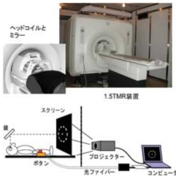
図1. 超伝導磁石による1.5Tの静磁界強度を有する磁気共鳴画像装置。下図は視覚刺激観察時の脳神経活動計測の様子。被験者は磁気共鳴画像装置のベットに仰向けに寝た状態で頭部用コイルに装着されたミラーを介して足側に設置されたスクリーンを観察する。
