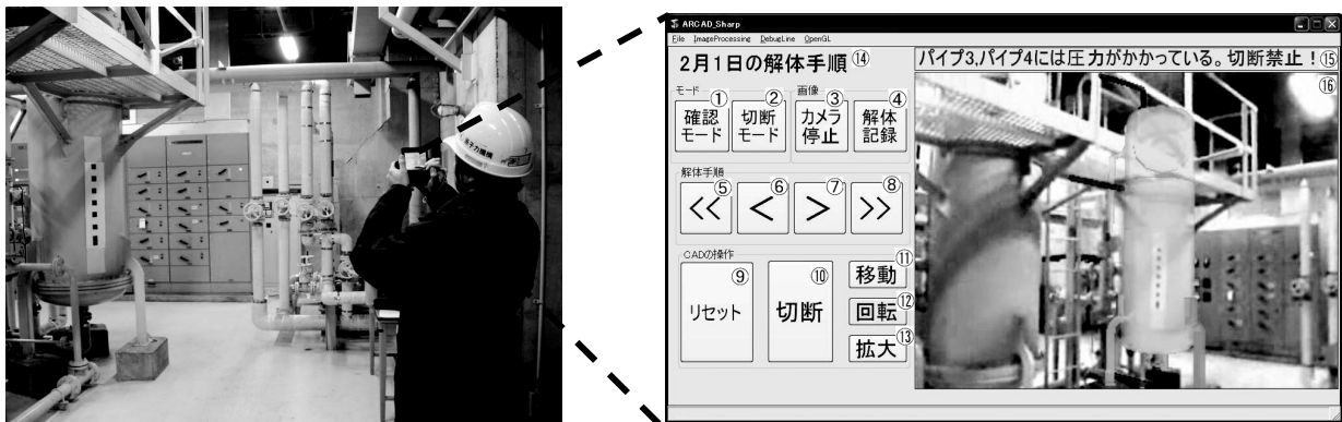
図1. 拡張現実感技術を用いた原子力発電プラント解体支援システム
