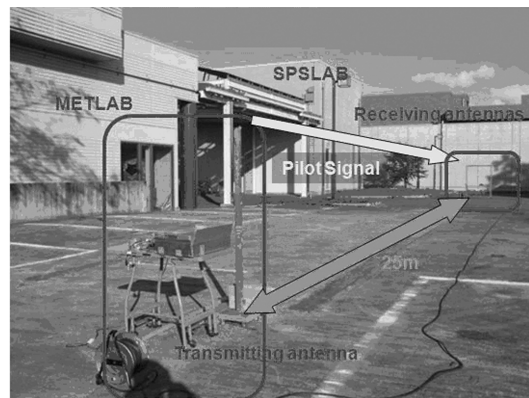
図1. 種々のビーム制御方式の比較（本文参照）。 写真1. 到来方向測定、レトロディレクティブシステムの屋外実験
