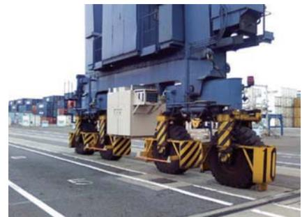
図8 トランスファークレーン搭載用ハイブリッド電源装置
