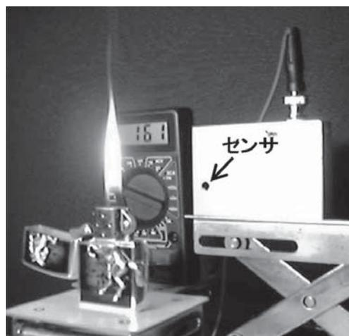
図  $Ga_2O_3$  深紫外光検出器により蛍光灯照明下で炎の検出を行っているところ。
