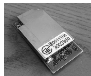
図 3 : メーター用（920MHz 帯、4cm × 2cm）Wi-SUN 無線通信機。
