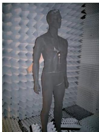
図2 測定に使用したマネキンおよび胸部に設置した拳銃。
