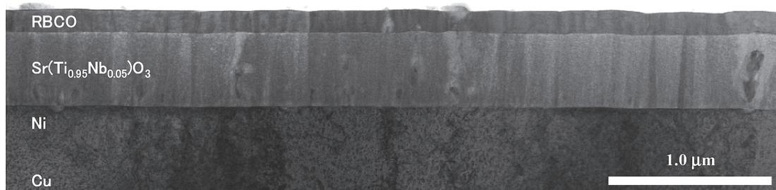
図 3 RBCO/Sr(Ti<sub>0.95</sub>Nb<sub>0.05</sub>)O<sub>3</sub>/Ni/Cu テープ試料断面の透過型電子顕微鏡観察結果
