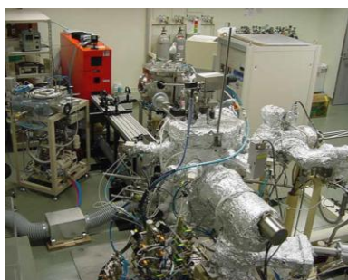
写真 2. レーザー蒸着装置とイオンビーム蒸着装置
