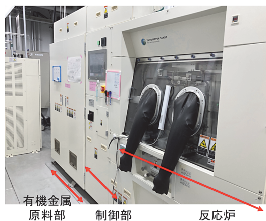
図 2：研究室で所有の MOVPE 装置
