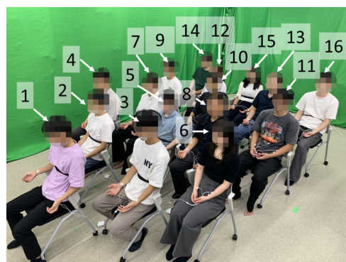
図4 電波による多人数の呼吸・心拍の同時計測
