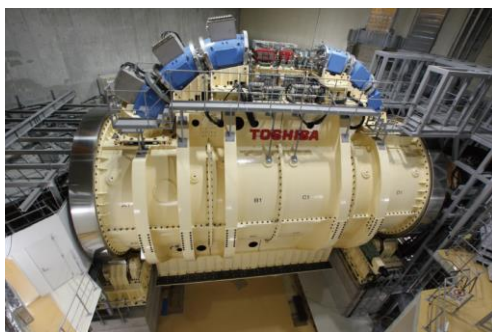
図 1 超伝導電磁石を用いた重粒子線がん治療装置：高速に加速した炭素イオンを照射してがんを治療
