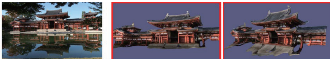
図3：京都のお寺など、水面に反射した姿とともに撮像された建築物の一枚の画像（左）から、彩り豊かな3次元モデルを復元できる（右の2枚）ことを示しました。
