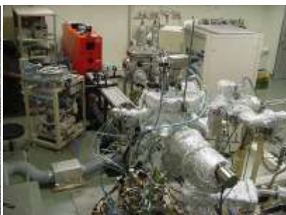
写真 2. レーザー蒸着装置とイオンビーム蒸着装置
