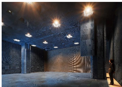
図 1 巨大なワイヤレス給電用実験装置 AMETLAB
