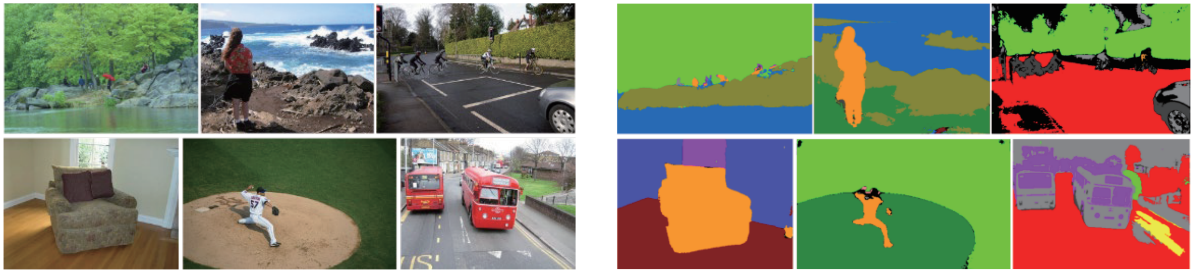
図1：左の写真の中の素材を各画素単位で認識した結果が右に示されています。素材を認識することにより、例えば布でできた椅子が木でできた床にある、などにより豊かな情景理解が可能になります。
