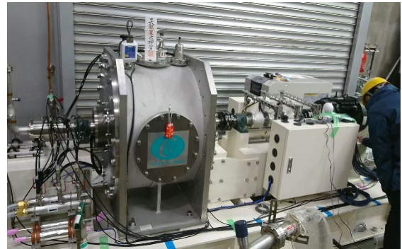
図3 液体水素冷却回転子模擬試験装置(40L,1800rpm)
