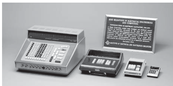
電卓の先駆的開発が認定されたIEEEマイルストーンの銘板および認定商品 左からオールドトランジスタ・ダイオード電卓、IC電卓、MOSLSI電卓、液晶電卓
