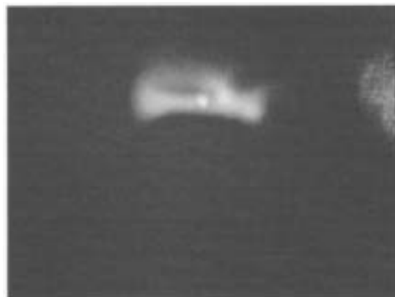
レーザーの輻射圧により冷却されたルビジウム原子の雲 (直径1mm, 温度 500\mu\text{K} , 原子数 10^6 個)
