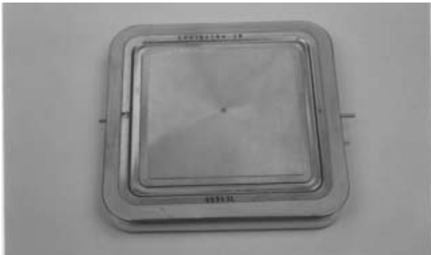
図4 700系に使用されている大容量（2500V-1800A）IGBT
