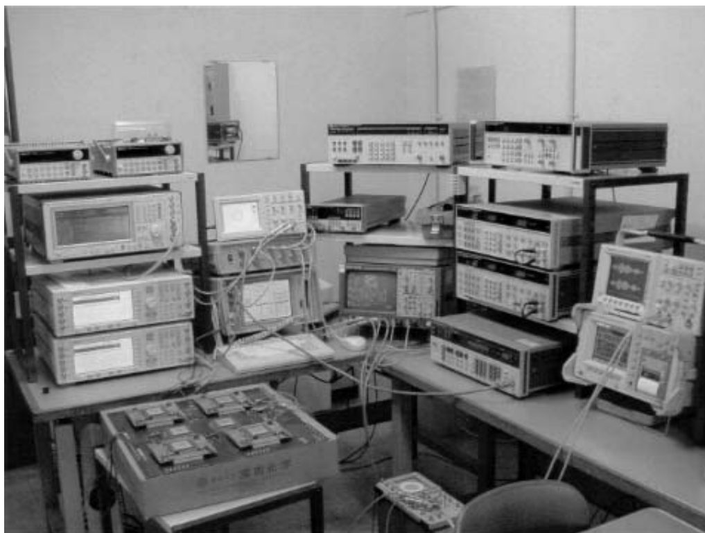
図1 無線信号処理の室内実験風景（遅延多重波と干渉波を同時に処理可能な信号処理アルゴリズムTCCを試作し、室内伝送実験を行っているところ）
