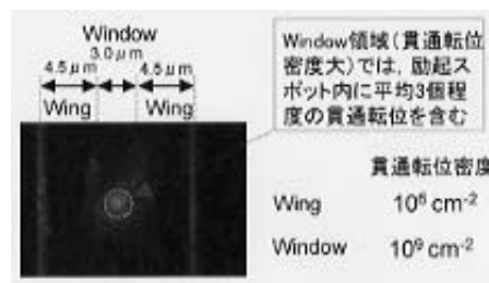
図3 選択成長GaNエピ膜状への集光拡大図
