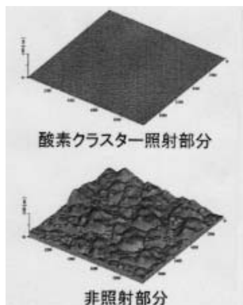
図1. 酸素クラスターイオン照射部分と未照射部分のITO薄膜表面のAFM像
