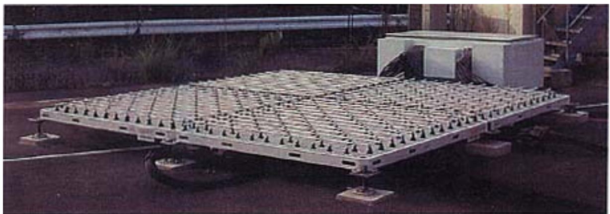
図1：京都大学で開発された小型大気レーダー。平成13年4月気象庁ウインドプロファイラ観測網に採用され全国展開された。
