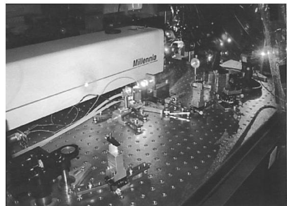
開発中のモードロックレーザシステム
