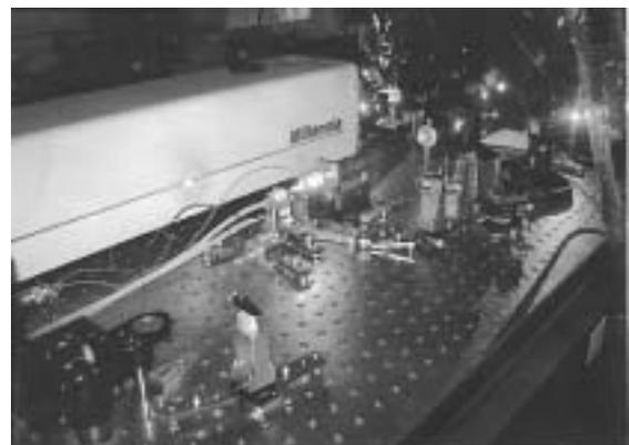
開発中のモードロックレーザーシステム
