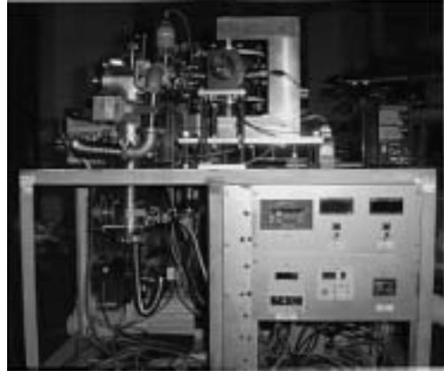
図1．エッセル可視分光器用絶対波長較正装置
