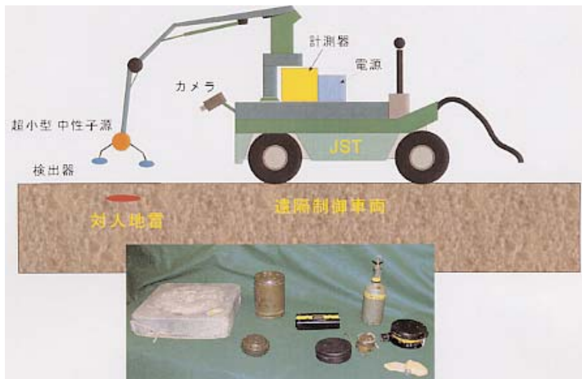
図5 超小型核融合中性子源を用いた地雷探知遠隔制御車両
