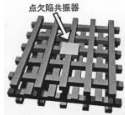
図1 3D PC点欠陥共振器（欠陥層を被う3D PCを除いた図）
