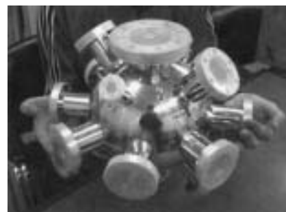
図4. 地雷探査用の超小型IECF中性子源（直径20cm）
