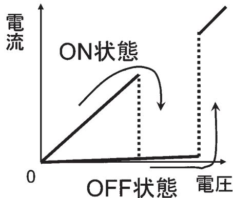
図1. NiO薄膜の電流一電圧特性
