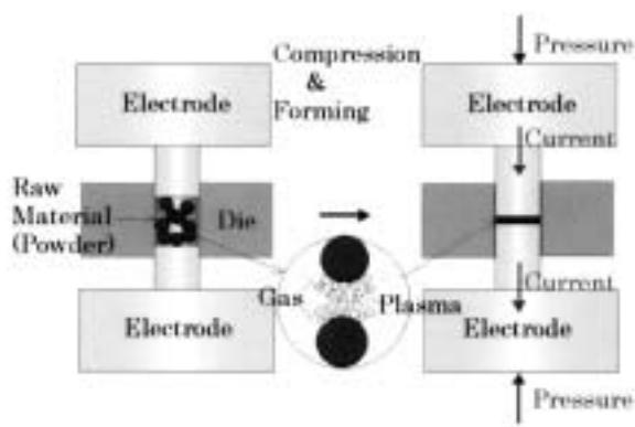
図2. パルス通電加熱法（畠, 2001より）
