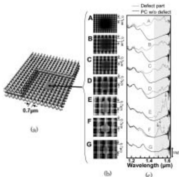
図1. 9層フォトニック結晶中の発光体欠陥の発光特性
