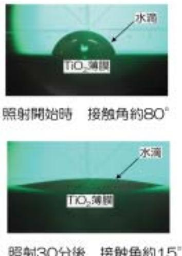
図 5. 紫外線照射した  $TiO_2$  薄膜上に滴下した水滴の形状変化
