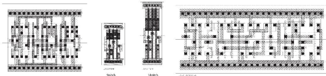
図2. 生成したスタンダードセルライブラリの例。左より： $0.18\text{ }\mu\text{m}$ プロセスのDフリップフロップ、 $0.35\text{ }\mu\text{m}$ プロセスのAOIゲート（2種類）、 $0.13\text{ }\mu\text{m}$ プロセスのリセット機能付Dフリップフロップ
