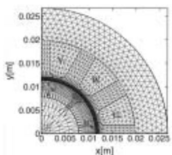
図2. モーターの計算格子（回転角0度）
