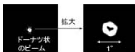
図2. 透視野像（ビームパターン）。大面積発振を反映して、非常に拡がり角の小さなビームが得られている。また、ビーム形状は、特徴的なドーナツビームが得られている。
