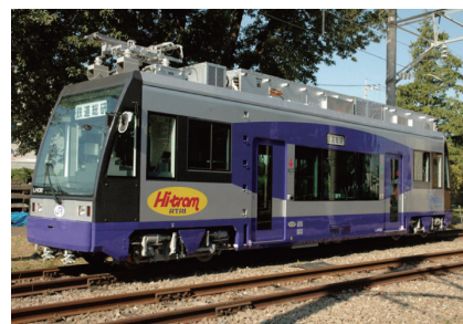
図6 架線・バッテリーハイブリッド車両「Hi-tram（ハイ！トラム）」 写真提供 財団法人鉄道総合技術研究所
