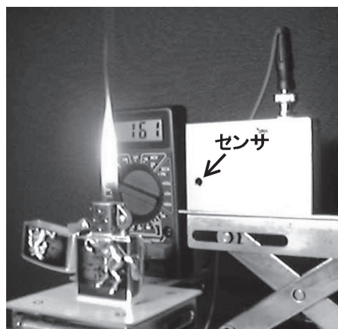
図 \text{Ga}_2\text{O}_3 深紫外光検出器により蛍光灯照明下で炎の検出を行っているところ。
