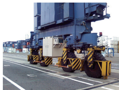
図8 トランスファークレーン搭載用ハイブリッド電源装置 写真提供 住友重機械エンジニアリング㈱
