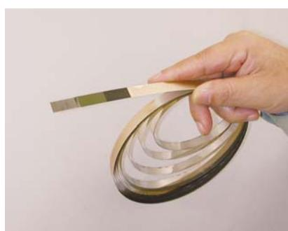
図1 薄膜超電導線
