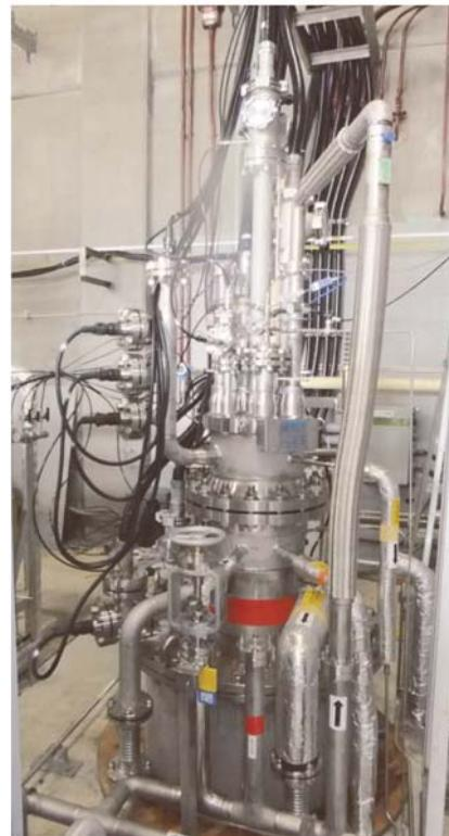
図 液体水素冷却超電導材料特性試験装置の写真
