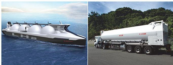
図3 液体水素タンカーと液体水素コンテナ（川崎重工）
