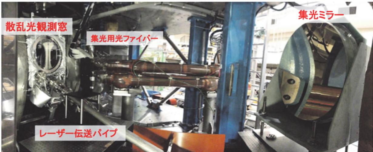
図5 トム森散乱計測装置受光システム
