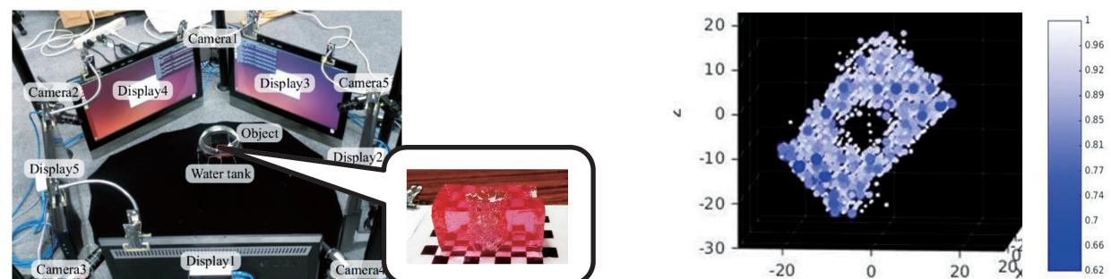
図2：水中半透明物体の3次元形状推定。左：計測環境。右：推定された透過率分布
