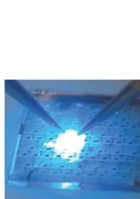
図 2 ScAlMgO<sub>4</sub> 上に試作した青色 LED。
