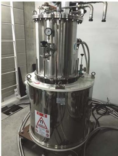
図1 伝導冷却超伝導線・コイルの特性評価装置(最大磁界5 T、最低温度10 K、最大電流500 A)
