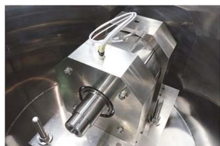
図1 20 kW級 HTS-ISM の外観写真
