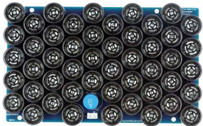
図 1. パラメトリックスピーカーの例（40kHz, 49 素子, 素子単体の超音波出力約 120 dB）[<https://www.switch-science.com/>]
