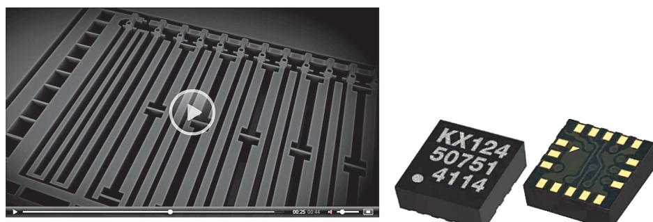
気圧センサは気圧変化による Si 抵抗（ピエゾ抵抗）のゆがみの変化を読み取るデバイスです。ローム製の気圧センサは 20cm の高度による気圧差 = 0.024hPa の精度での検出が可能なほどの低ノイズを実現しています。単に外気圧を測定するのみならず、室内の環境調整、装置・チャンバ内の状態監視、自然環境のモニタリングにも応用が可能です。
