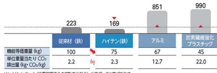
図2 従来材(鉄) 100kgと同じ強さの自動車部材を作るときのCO<sub>2</sub>排出量
