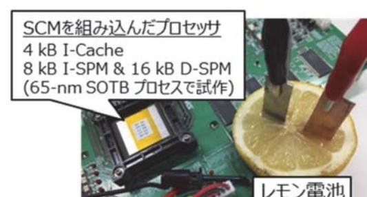
図 3 : レモン電池で動くプロセッサ。
