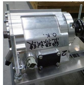
図 2 最大出力 24 kW 級誘導機の外観写真 [4]
