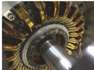
図 1: JST-ALCA プロジェクトで開発した全高温超伝導誘導同期モータの写真 [1,2]
