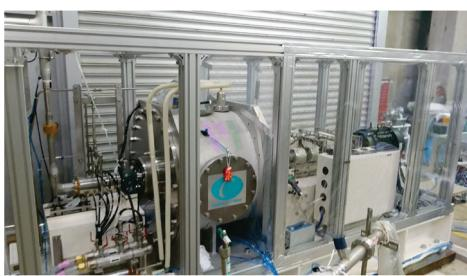
図1 液体水素冷却模擬回転子試験装置
