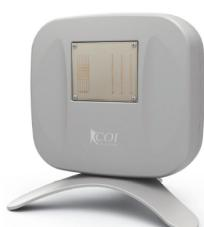
図1 開発したミリ波非接触見守りセンサ
