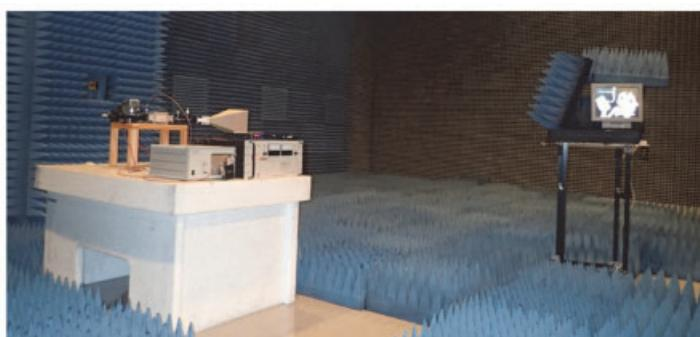
図1：電力情報同時伝送マグネットロン・ワイヤレステレビ
