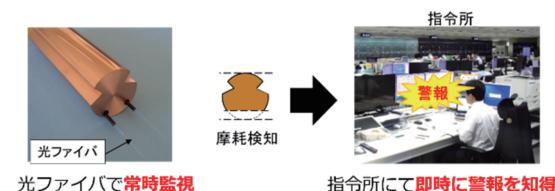
図9 光ファイバ警報トロリ線システム
