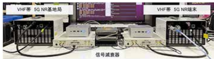
図 2：開発した超広域小型自営系 5G システムの評価系
