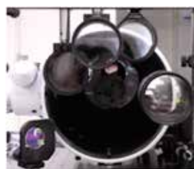
図1 大気ライダー用ウェッジプリズム光学系。観測視野方向が異なる複数のウェッジプリズムを組み合わせることで、信号飽和を抑えながら近傍からの計測を可能としている。
