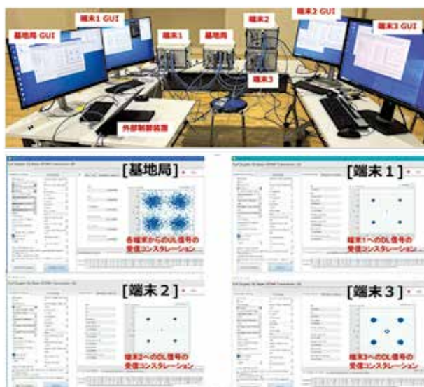
図7：開発した Full-Duplex セルラーシステム
