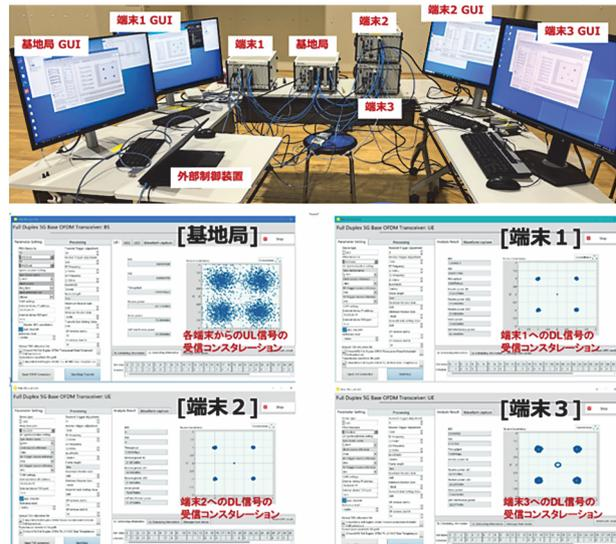
図7: 開発した Full-Duplex セルラーシステム
