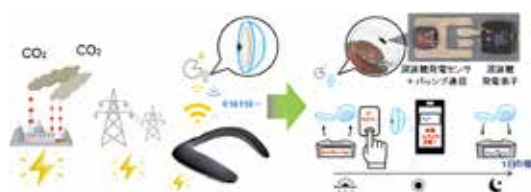
図3：エネルギー・データ地産地消方式による単独自立動作可能持続血糖モニタリングスマートコンタクトレンズのコンセプト図
