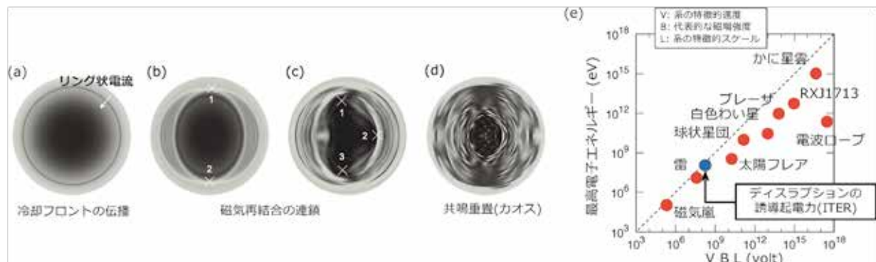
図1 (a-d) 不純物混入によるディスラプションの発生。輻射電磁流体シミュレーションによる。 (e) ITERの誘導起電力と自然界の粒子加速現象の比較（Makishima 1999に基づく）。
