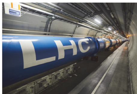
図4 Large Hadron Collider (LHC) の低温超伝導電磁石 [3]。地下のトンネル内に超伝導電磁石が並べられてリングを構成している。
