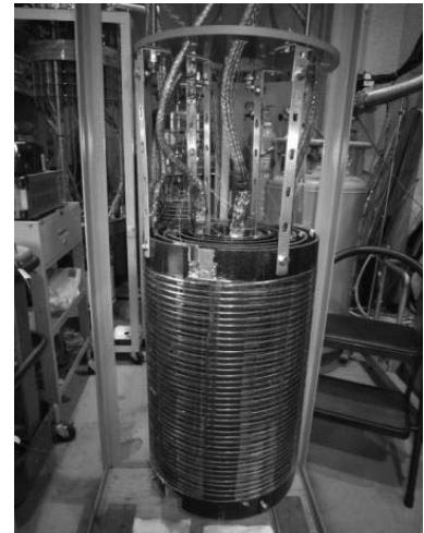
図1 製作した三相同軸超電導限流器
